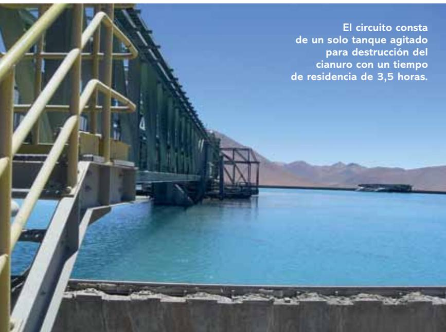
El circuito consta de un solo tanque agitado para destrucción del cianuro con un tiempo de residencia de 3,5 horas.
