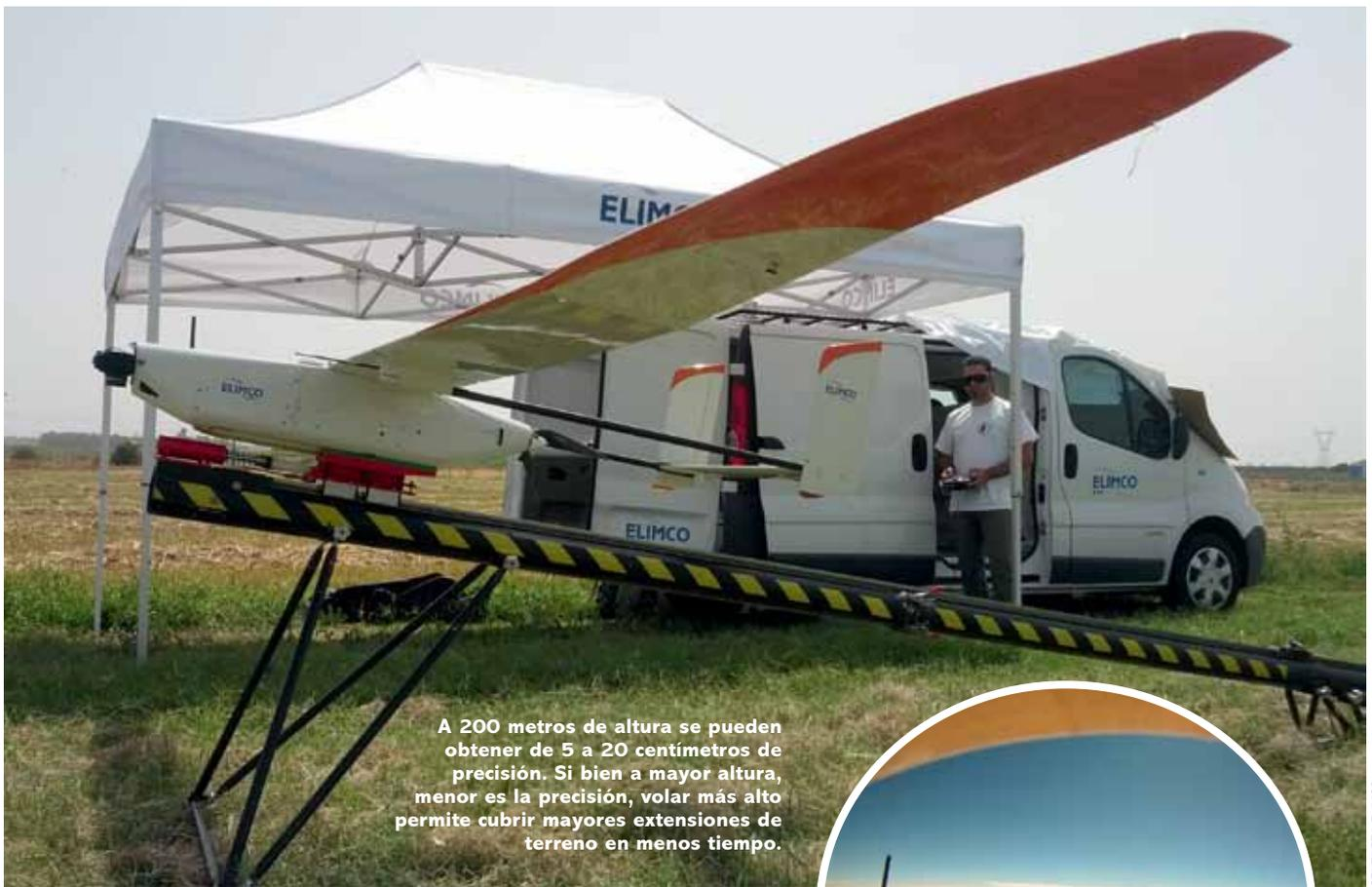
A 200 metros de altura se pueden obtener de 5 a 20 centímetros de precisión. Si bien a mayor altura, menor es la precisión, volar más alto permite cubrir mayores extensiones de terreno en menos tiempo.
