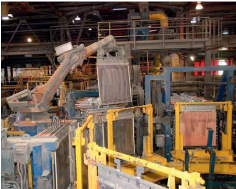
Manejo de cátodos en electro obtención, Radomiro Tomic. Corresponde a una solución robótica equipada con un gripper para levantar, mover y dejar los diferentes cátodos en su área de trabajo. Sus sensores y sistema de comunicación permiten que pueda trabajar con diversas máquinas despegadoras automáticas. También evita los espacios vacíos en la siembra de placas bases.
