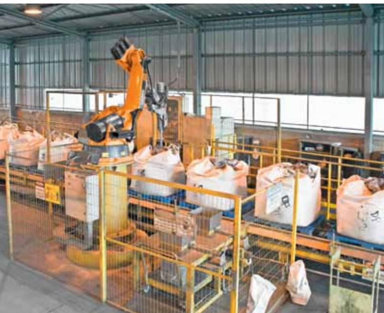
Toma de muestra maxisacos de molibdeno. El muestreo en los maxisacos demora 60 segundos por unidad. Para cada maxisaco el robot lo identifica, posiciona, toma los incrementos de acuerdo al programa y los deposita en un contenedor. Un operador abre los maxisacos y repone los contenedores.
