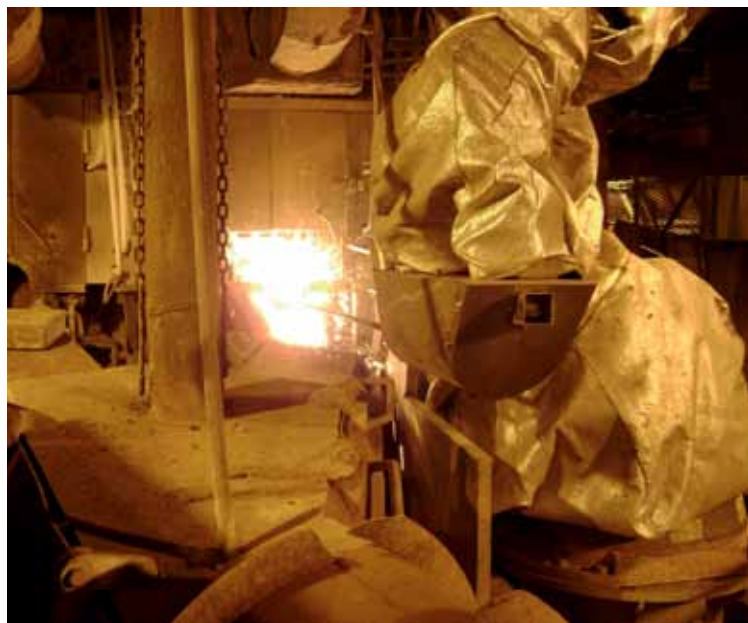
Quemado y taponeo de pasajes en hornos de fusión. El robot abre el canal de descarga de escoria mediante quemado o punzonado, toma la muestra en caliente y taponea el agujero de descarga. Luego el robot toma una herramienta de muestreo, toma un ejemplar y lo deposita en un contenedor. Así, evita que una persona se exponga a esta labor peligrosa a una temperatura superior a los 1.200 grados Celsius.
