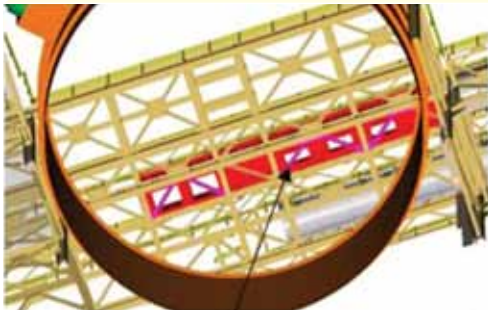
Vista inferior de los “buzones” o descargas de la extensión de la canaleta.
