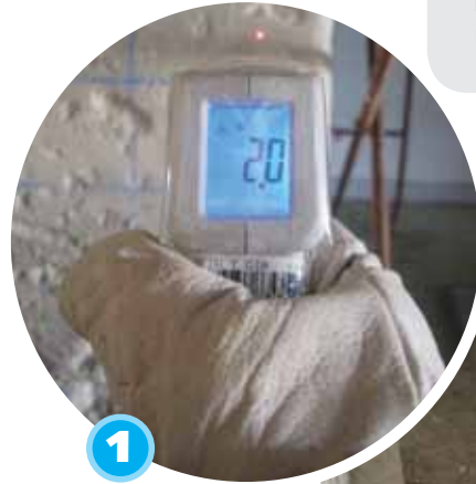
Control de temperatura en muros exteriores antes de comenzar las faenas.
