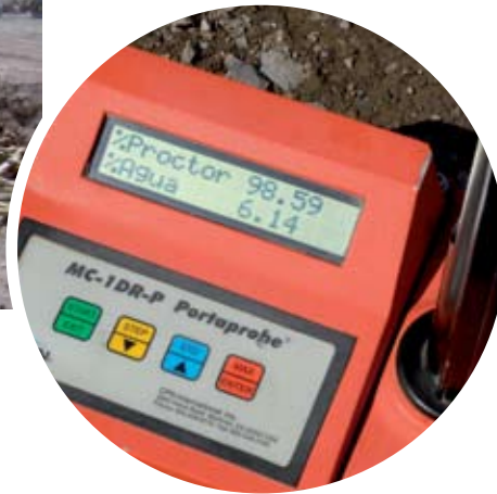
Control de densidad en terreno por medio del método del cono de arena. A la derecha, densímetro nuclear.
