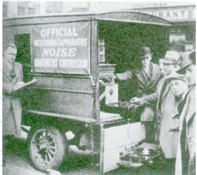
Vehículo para la medición del ruido en la ciudad de Nueva York, 1929.
