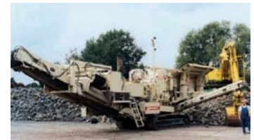
Planta móvil procesadora de árido reciclado (España).
